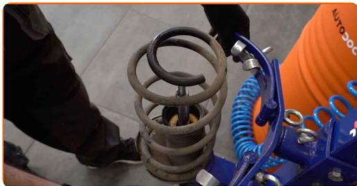
**33** Instale o novo suporte de amortecedor e aperte-o.
