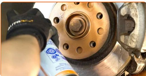
**20** Limpe a superfície do disco de travão. Utilize um produto de limpeza para travões.
