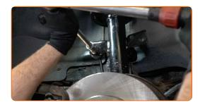
Aperte o fixador que conecta a bieleta da barra estabilizadora à barra estabilizadora. Use uma chave combinada nº 19. Use uma chave soquete nº 19. Use HEX n.º H6. Use uma chave de torque. Aperte-o para o torque de 48 Nm.
