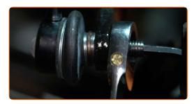
Desaparafuse o fixador que conecta bieleta da barra estabilizadora à barra estabilizadora. Use uma chave combinada nº 19. Use uma chave soquete nº 19. Use HEX n.º H6. Use uma chave de torque. Aperte-o para o torque de 48 Nm.
