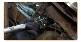
Trate todas as juntas de conexão do estabilizador. Use massa de cobre.
