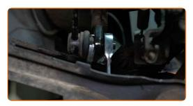
9 Remova a biela da barra estabilizadora.
