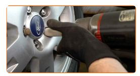
Baixar o carro e trabalhar em ordem transversal, apertar os parafusos das rodas. Use o soquete de impacto para roda #19. Use uma chave de torque. Aperte-o para o torque de 90 Nm.
