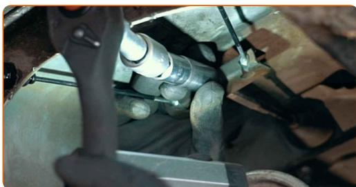
**23** Instale a proteção térmica do escape.
