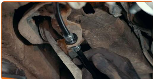
**21** Instale o cabo do travão de estacionamento no suporte da pinça do travão. Use um alicate de corte. Utilize um pé-de-cabra.
