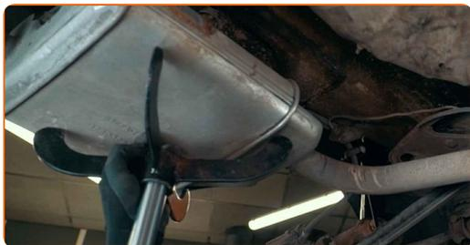
**12** Desparafuse os fixadores da proteção térmica do escape. Use uma chave soquete nº 10. Use uma chave de catraca.
