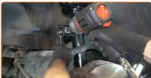
**77** Desparafuse o fixador que conecta bieleta da barra estabilizadora à barra estabilizadora. Use uma chave soquete nº 17. Use uma chave de torque. Aperte-o para o torque de 48 Nm.
