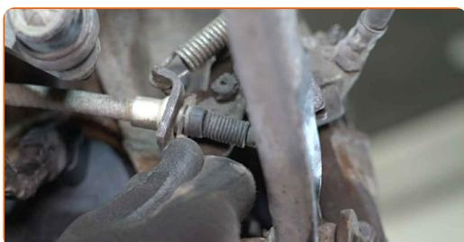
**74** Limpe os assentos de montagem do tirante da barra estabilizadora. Use uma escova metálica. Use spray WD-40.
