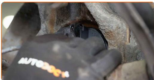
**72** Instale a pinça do travão e fixe-o. Use uma chave soquete nº 13. Use uma chave de torque. Aperte-o para o torque de 30 Nm.
