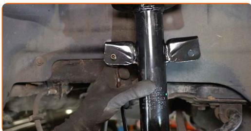
**76** Aperte o fixador da bieleta da barra estabilizadora. Use uma chave soquete nº 17. Use uma chave de catraca.
