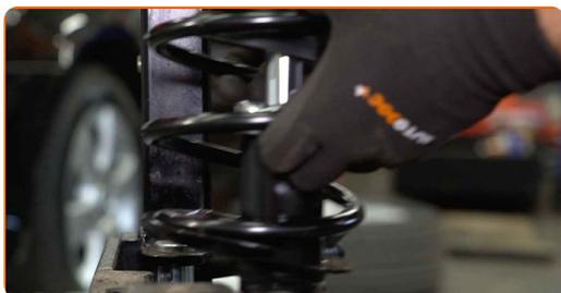
**51** Limpe os assentos de montagem da coluna do amortecedor. Use uma escova metálica. Use spray WD-40.
