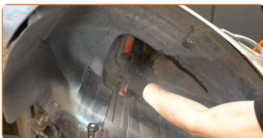
**50** Instale o amortecedor no arco da roda.
