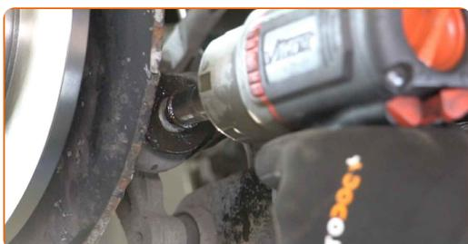
**19** Remova o parafuso de fixação. Separe o braço de controlo.
