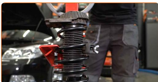
**48** Retire a coluna de suspensão montada.
