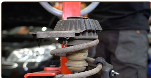
**35** Trate a haste da coluna do amortecedor. Use uma escova metálica. Use spray WD-40.
