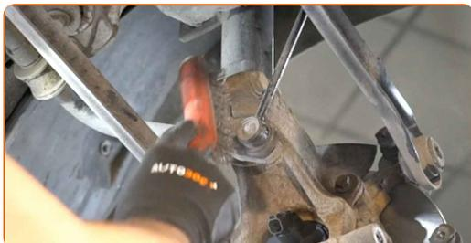
**22** Desparafuse o elemento fixador, que liga o braço de suspensão à manga de eixo traseira. Use uma chave soquete nº 18. Use uma chave de catraca. Use uma chave de tarraxa.
