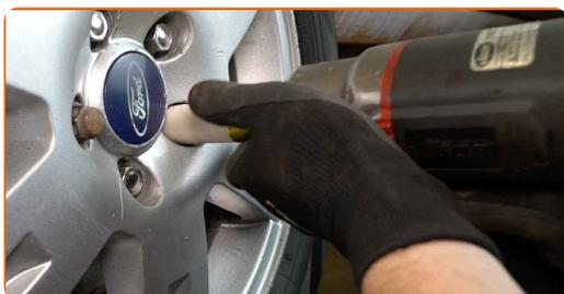
**81** Baixar o carro e trabalhar em ordem transversal, apertar os parafusos das rodas. Use o soquete de impacto para roda #19. Use uma chave de torque. Aperte-o para o torque de 90 Nm.
