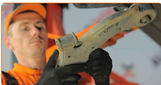
**23** Limpe os locais de montagem e a rosca do braço da suspensão. Use uma escova metálica. Use spray WD-40.
