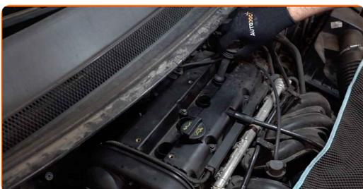
Substituição: vela de ignição – FORD MONDEO IV três volumes (BA7).
