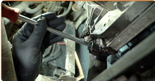
9 Desapertar a braçadeira de mola do tubo do líquido de refrigeração. Utilizar um alicate para braçadeiras de mola.
