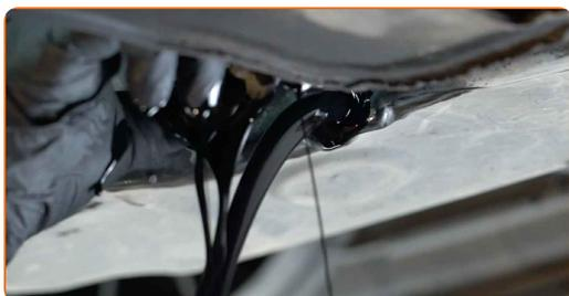
Substituição: óleo do motor e filtro – FORD TOURNEO CONNECT. AUTODOC recomenda:
