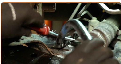
**18** Montar um novo casquilho da barra estabilizadora num dos lados do eixo.
