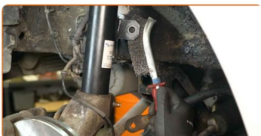
**12** Montar uma nova biela da barra estabilizadora e os respetivos elementos de fixação.
