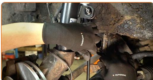
**13** Apertar o elemento de fixação que liga a biela à barra estabilizadora. Utilizar uma chave combinada de 20 mm. Utilizar uma chave de caixa de 17 mm. Utilizar uma chave dinamométrica. Binário de aperto: 55 N·m.
