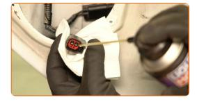
Tratar o conector do interruptor do vidro elétrico. Utilizar um spray para componentes eletrónicos.
