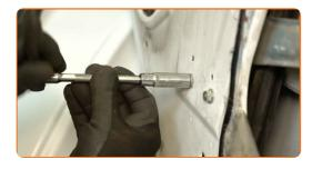
18 Retirar os parafusos de fixação.
