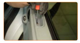
Desmontar o revestimento do puxador da porta.
