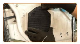
Montar e apertar os parafusos de fixação do altifalante. Usar uma chave de fendas Phillips.
