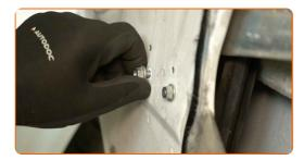
Desmontar o mecanismo do elevador do vidro.
