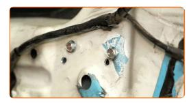
Aparafusar os elementos de fixação do mecanismo do elevador do vidro. Utilizar uma chave de caixa de 10 mm. Utilizar uma chave dinamométrica. Binário de aperto: 8 N·m.
