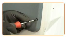
Desmontar o painel da porta. Utilizar uma ferramenta para desmontar revestimentos de plástico.
