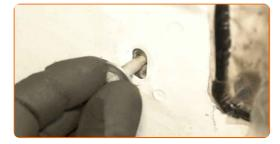
Aparafusar o elemento de fixação da calha guia da janela. Utilizar uma chave de caixa de 8 mm. Utilizar uma chave dinamométrica. Binário de aperto: 6 N·m.
