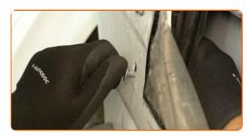
Desaparafusar os elementos de fixação do mecanismo do elevador do vidro. Utilizar uma chave de caixa de 10 mm. Utilizar uma chave de roquete.
