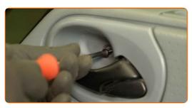
Apertar os elementos de fixação do painel da porta. Usar uma chave de fendas Phillips.
