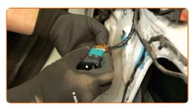
Tratar o conector do altifalante. Utilizar um spray para componentes eletrónicos.
