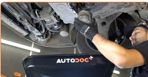
Substituição: óleo do motor e filtro – FORD TRANSIT Camião de plataforma/chassis (T\_ \_). Os especialistas da AUTODOC recomendam:
