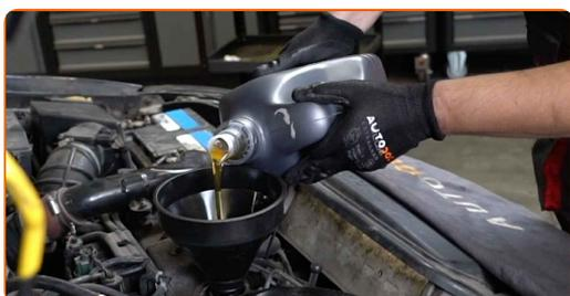
Substituição: óleo do motor e filtro – FORD TRANSIT Camião de plataforma/chassis (T\_ \_). Os profissionais recomendam:
