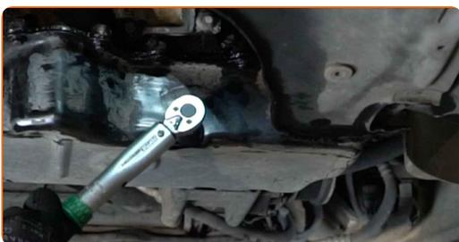
**18** Limpe a área do orifício de drenagem do cárter. Use o spray de limpeza universal.
