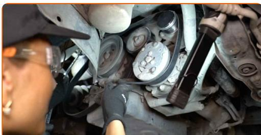
**Substituição: correia trapezoidal estriada – FORD Transit Connect Mk1 Van.**
