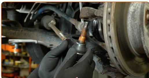
Substituição: terminal de direção – FORD Transit Connect Mk2 Carrinha.
