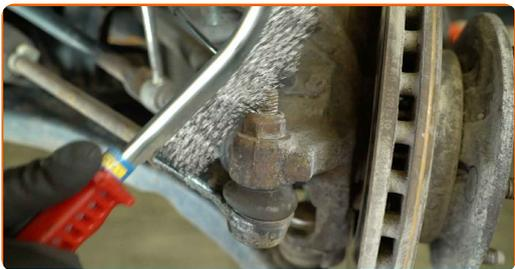
**7** Medir e anotar o comprimento da parte exposta da rosca da barra de direção ou o número de voltas que o terminal da barra de direção realizou ao ser desenroscado para evitar o desalinhamento da roda durante a remontagem. Utilizar um paquímetro.
