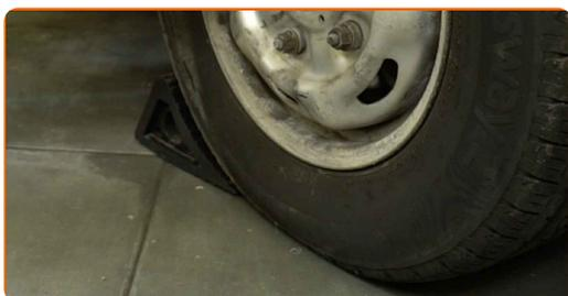
**2** Desapertar as porcas das rodas. Utilizar uma chave de impacto de 21 mm para rodas. Utilizar uma chave de roda tipo L.
