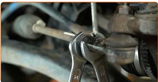
**9** Desaparafusar a porca que liga o terminal da barra de direção à manga de eixo. Utilizar uma chave de caixa de 22 mm. Utilizar uma chave de roquete.
