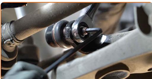
**12** Desaparafuse o fixador que conecta bieleta da barra estabilizadora à barra estabilizadora. Use uma chave soquete nº 15. Use uma chave de torque. Aperte-o para o torque de 48 Nm.
