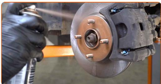
**16** Limpe a superfície do disco de travão. Utilize um produto de limpeza para travões.
