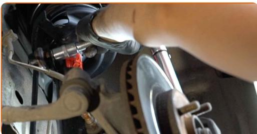
**13** Aperte o fixador que conecta a bieleta da barra estabilizadora à barra estabilizadora. Use uma chave soquete nº 15. Use uma chave de torque. Aperte-o para o torque de 48 Nm.
