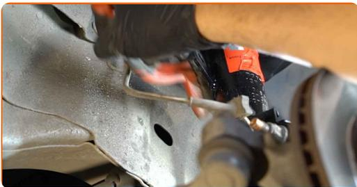
**11** Instale uma nova barra, aperte os parafusos de fixação. Use uma chave combinada nº 15. Use HEX n.º H5. Use uma chave de catraca.
