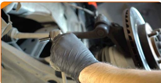
Substituição: tirante da barra estabilizadora – FORD Transit Connect V408 Van. AUTODOC recomenda:
