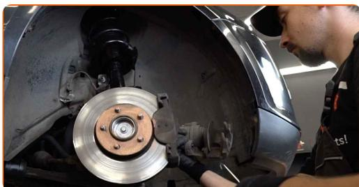
**Substituição: pastilhas de travão – FORD Transit Connect V408 Van.
