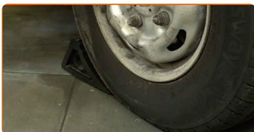
**2** Desapertar as porcas das rodas dianteiras. Utilizar uma chave de impacto de 21 mm para rodas. Utilizar uma chave de roda tipo L.
