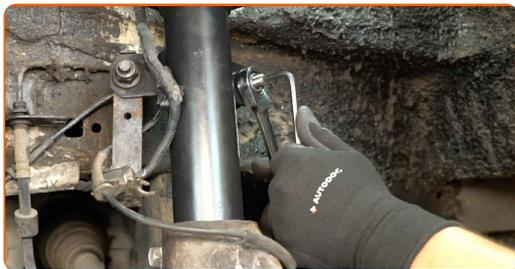
**11** Limpar os assentos de montagem da biela da barra estabilizadora num dos lados do eixo. Utilizar uma escova de arame. Utilizar spray de limpeza multiusos.
