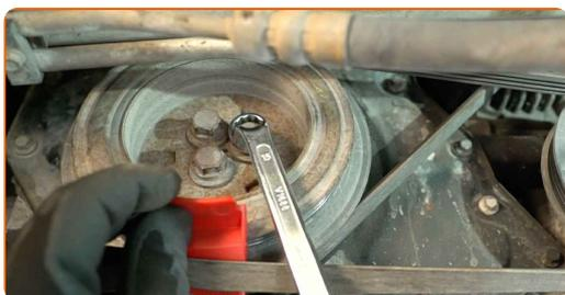
**3** Desmontar a correia trapezoidal estriada do alternador rodando a polia da cambota. Utilizar uma ferramenta de desmontagem/montagem de correias elásticas. Utilizar uma alavanca de montagem. Utilizar uma chave combinada de 15 mm.
