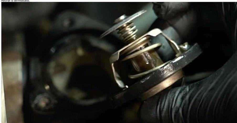
16 Limpar o local de montagem da tampa da carcaça do termóstato. Utilizar spray de limpeza multiusos.
