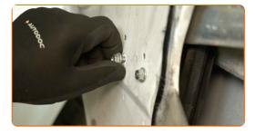
Desmontar o mecanismo do elevador do vidro.
