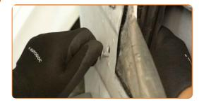
Desaparafusar os elementos de fixação do mecanismo do elevador do vidro. Utilizar uma chave de caixa de 10 mm. Utilizar uma chave de roquete.
