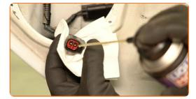
Tratar o conector do interruptor do vidro elétrico. Utilizar um spray para componentes eletrónicos.
