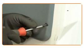
Desmontar o painel da porta. Utilizar uma ferramenta para desmontar revestimentos de plástico.
