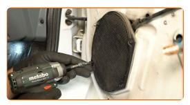
B Desenroscar os parafusos de fixação.
