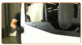
Desaparafusar os elementos de fixação do painel da porta. Usar uma chave de fendas Phillips.
