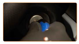
Desligar o conector do interruptor do vidro elétrico.
