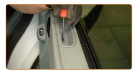
Desmontar o revestimento do puxador da porta.
