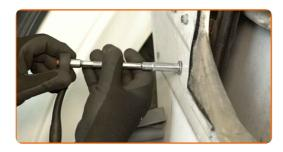
Retirar o parafuso de fixação.
