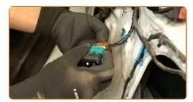
Tratar o conector do altifalante. Utilizar um spray para componentes eletrónicos.
