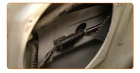
Montar o parafuso de fixação da calha guia da janela.
