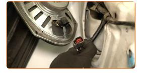
Desligar o conector do motor do vidro elétrico.
