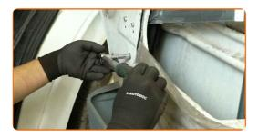
Montar os rebites que ligam o vidro ao mecanismo do elevador do vidro. Utilizar um rebitador. Utilizar rebites.
