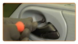
Apertar os elementos de fixação do painel da porta. Usar uma chave de fendas Phillips.
