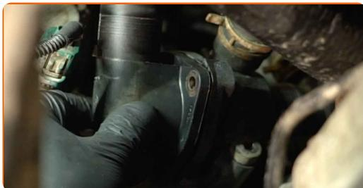
**19** Montar os parafusos de fixação.
