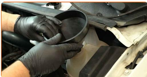
**24** Verter o líquido de refrigeração no depósito.
