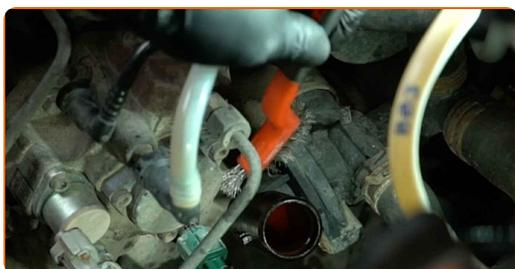
**12** Desaparafusar os elementos de fixação da tampa da carcaça do termóstato. Utilizar um bit Torx T25. Utilizar uma extensão de chave com cardan. Utilizar uma chave de roquete.
