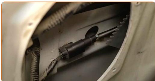
**24** Montar o parafuso de fixação da calha guia da janela.
