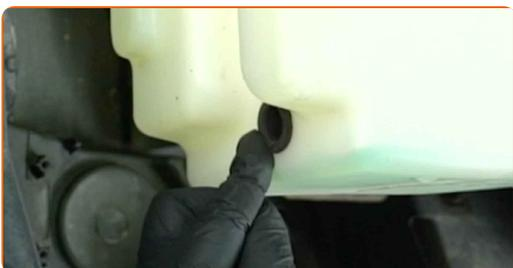
**20** Montar uma nova bomba do limpa-vidros.
