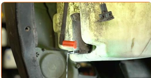
**16** Desmontar a bomba do limpa-vidros. Utilizar um alicate de remoção para mangueiras.
