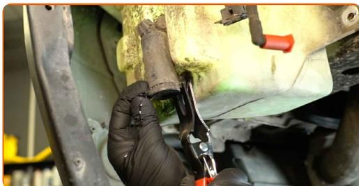
**17** Retirar o vedante da bomba do limpa-vidros. Utilizar uma alavanca de montagem.
