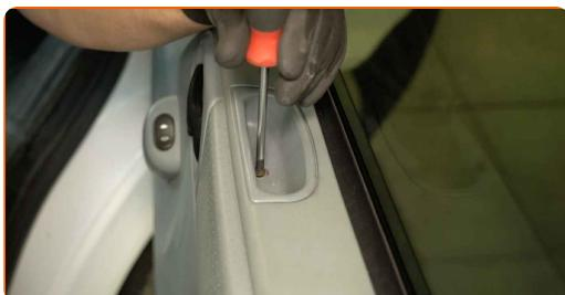
3 Desmontar o revestimento do puxador da porta.
