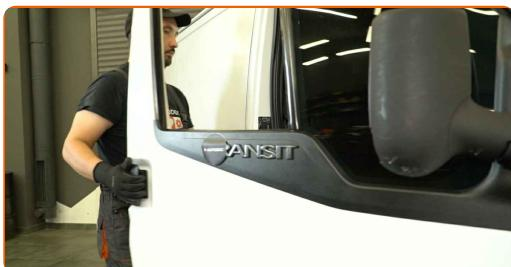
2 Desaparafusar os elementos de fixação do painel da porta. Usar uma chave de fendas Phillips.
