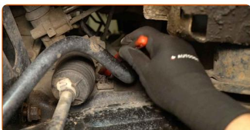
**12** Desapertar os elementos de fixação do suporte do casquilho da barra estabilizadora. Utilizar uma chave de caixa de 10 mm. Utilizar uma chave de roquete.
