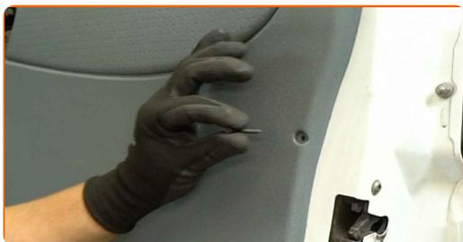
**5** Desmontar o painel da porta. Utilizar uma ferramenta para desmontar revestimentos de plástico.
