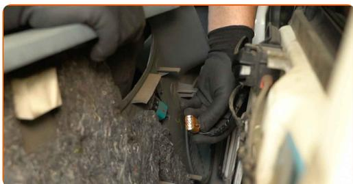
**7** Desencaixar a haste de bloqueio que liga a fechadura ao puxador exterior da porta.
