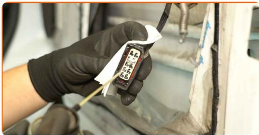
**17** Fixar o cabo do trinco a uma nova fechadura de porta.
