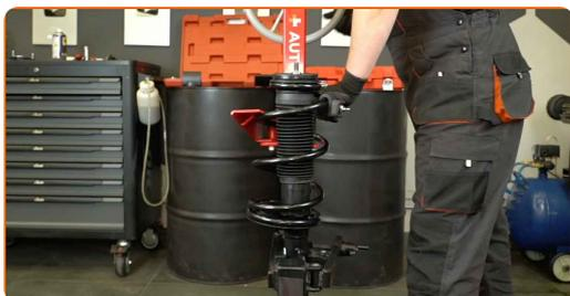
**61** Montar um cabeçote superior do amortecedor.
