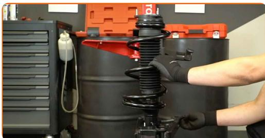
**64** Desmontar o conjunto do amortecedor do compressor de molas.
