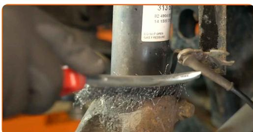
**21** Desapertar o elemento de fixação do suporte do cabo do sensor ABS. Utilizar uma chave de caixa de 18 mm. Utilizar uma chave de roquete.
