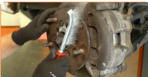
**83** Limpar a superfície do cubo da roda que está em contacto com a jante. Utilizar massa lubrificante de cerâmica.
