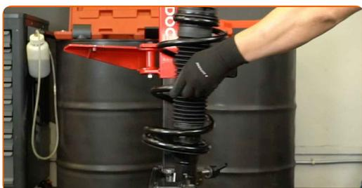
**65** Montar o conjunto do amortecedor no arco da roda.
