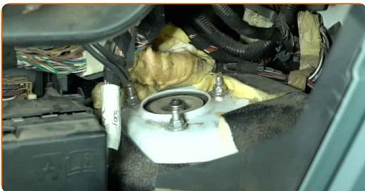
**6** Limpar os elementos de fixação do cabeçote superior do amortecedor. Utilizar uma escova de arame. Utilizar spray WD-40.
