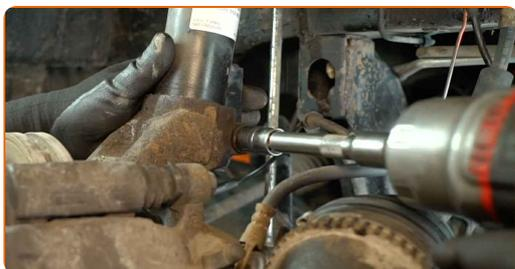
**41** Retirar o parafuso de fixação.
