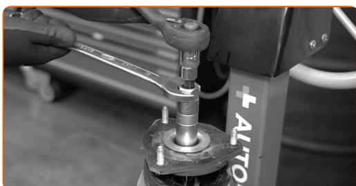
**53** Desmontar o cabeçote superior do amortecedor.
