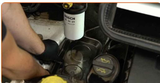
**4** Limpar a zona de montagem do filtro. Utilizar spray de limpeza multiusos.
