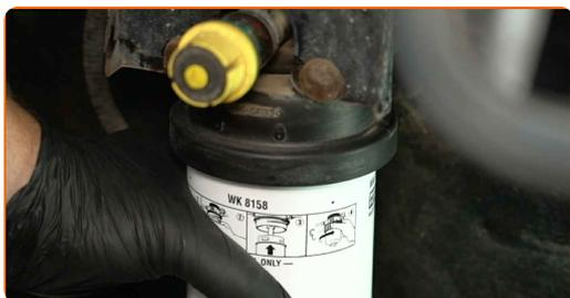
Substituição: filtro de combustível – FORD Transit Mk6 Minibus (V347, V348).
