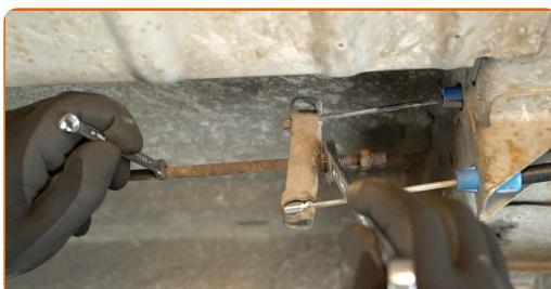
**34** Apertar a contraporca sobre a porca de regulação. Utilizar duas chaves combinadas de 13 mm.
