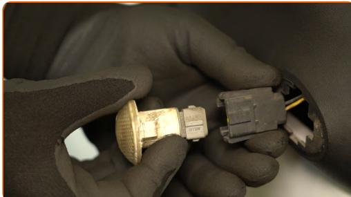
3 Tratar o conector da luz do pisca auxiliar. Utilizar um spray para componentes eletrónicos.
