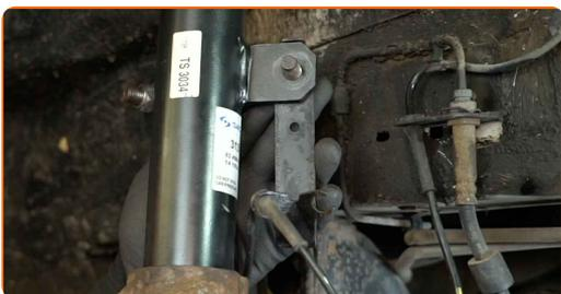
**78** Apertar o elemento de fixação que liga a biela da barra estabilizadora ao amortecedor. Utilizar uma chave de caixa de 19 mm. Utilizar uma chave dinamométrica. Binário de aperto: 55 N·m.
