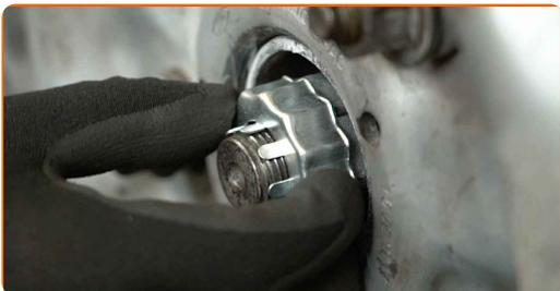
**91** Montar o contrapino. Utilizar uma alavanca de montagem.
