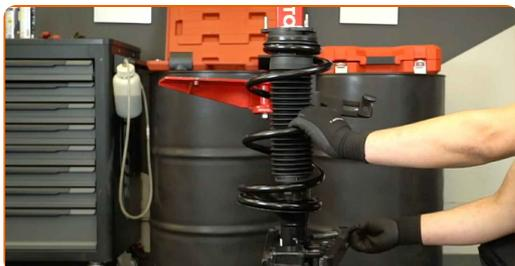
**66** Desmontar o conjunto do amortecedor do compressor de molas.
