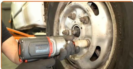
**88** Baixar o veículo e apertar as porcas da roda em cruz. Utilizar uma chave de impacto de 21 mm para rodas. Utilizar uma chave dinamométrica. Binário de aperto: 200 N·m.
