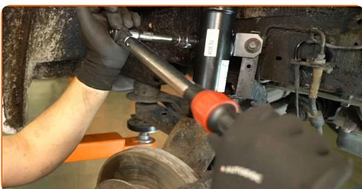
**79** Apertar o elemento de fixação do suporte do cabo do sensor ABS. Utilizar uma chave de caixa de 18 mm. Utilizar uma chave dinamométrica. Binário de aperto: 45 N·m.
