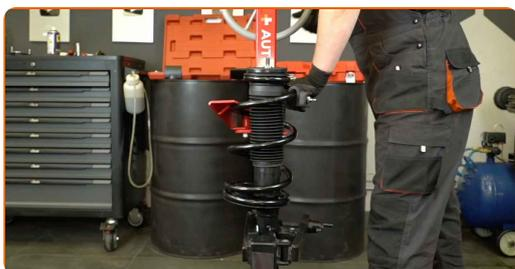
**63** Montar um cabeçote superior do amortecedor.
