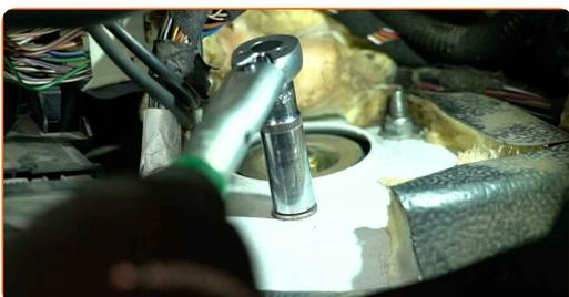
**95** Voltar a cobrir os elementos de fixação do cabeçote do amortecedor com o isolamento.
