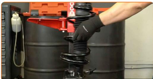
**67** Montar o conjunto do amortecedor no arco da roda.
