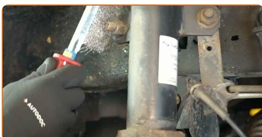
**19** Limpar o elemento de fixação do suporte do cabo do sensor ABS. Utilizar uma escova de arame. Utilizar spray WD-40.
