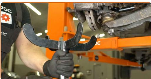
Substituição: kit de suspensão – FORD Transit Mk6 Minibus (V347, V348).
