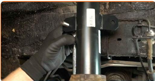
**77** Montar o suporte do cabo do sensor ABS e aparafusar a porca de fixação.
