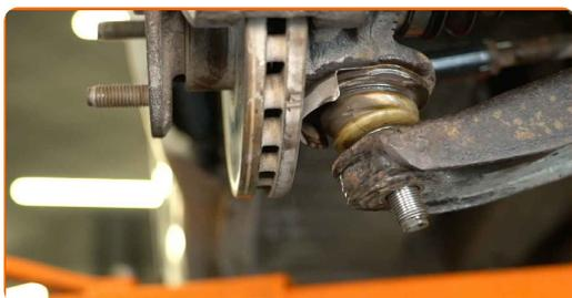
**76** Montar a biela da barra estabilizadora e aparafusar a porca de fixação.
