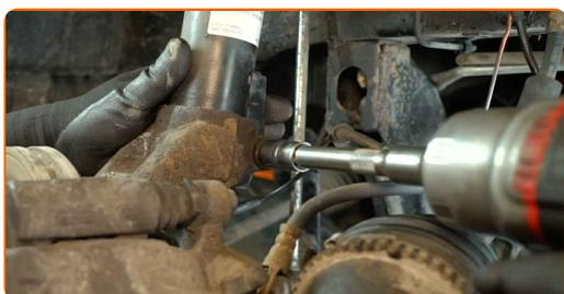
**41** Retirar o parafuso de fixação.
