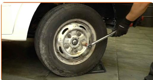
**89** Apertar a porca do eixo. Utilizar uma chave de caixa de 36 mm. Utilizar uma chave dinamométrica. Binário de aperto: 320 N·m.
