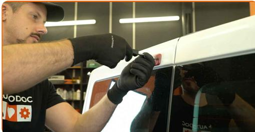
**2** Desenroscar os parafusos de fixação.
