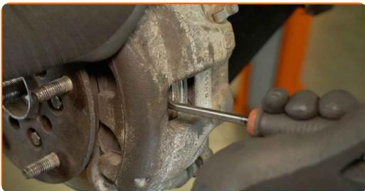
9 Limpar os elementos de fixação da pinça de travão. Utilizar uma escova de arame. Utilizar spray WD-40.
