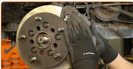
21 Montar os parafusos de fixação.
