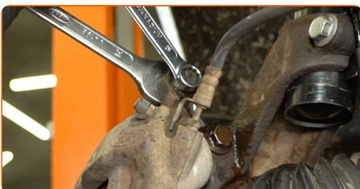
11 Retirar os parafusos de fixação.
