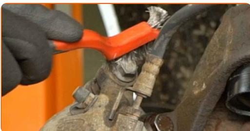
10 Desapertar os elementos de fixação da pinça de travão. Utilizar uma chave combinada de 21 mm. Utilizar uma chave de caixa de 15 mm. Utilizar uma chave de roquete.
