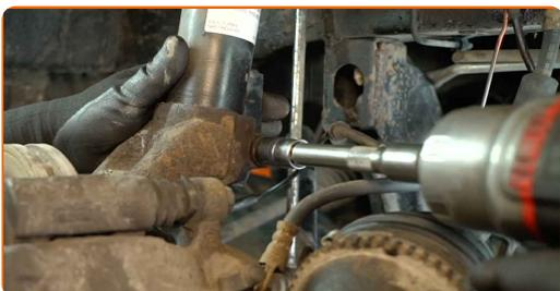
**41** Retirar o parafuso de fixação.
