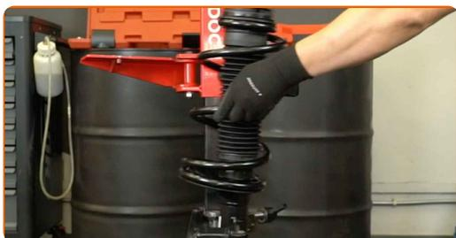
**63** Montar o conjunto do amortecedor no arco da roda.
