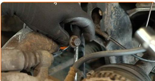
**42** Separar a manga de eixo do amortecedor. Utilizar um martelo de borracha. Utilizar um macaco para a caixa de velocidades ou mais um macaco para veículos.
