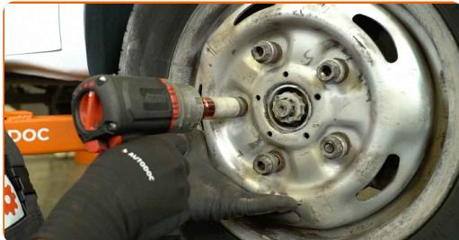
**22** Baixar o veículo e apertar as porcas da roda em cruz. Utilizar uma chave de impacto de 21 mm para rodas. Utilizar uma chave dinamométrica. Binário de aperto: 200 N·m.
