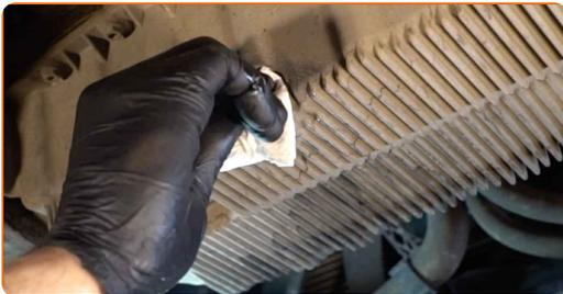
**18** Aparafuse o novo bujão de drenagem e aperte-o. Use uma chave soquete nº 19. Use uma chave de torque. Aperte-o para o torque de 27 Nm.
