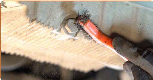
9 Desaperte o bujão de drenagem. Use uma chave soquete nº 19. Use uma chave de catraca.
