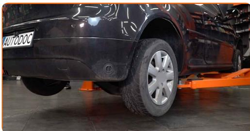
5 Desaperte os parafusos da roda.
