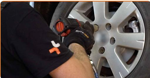
21 Baixar o carro e trabalhar em ordem transversal, apertar os parafusos das rodas. Use uma chave de torque. Aperte-o para o torque de 120 Nm.
