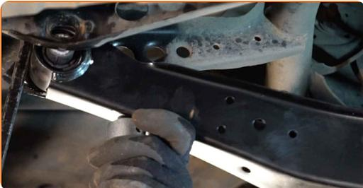
**32** Instale o parafuso de fixação.
