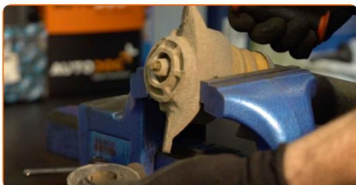
19 Limpe o elemento de fixação de componentes do amortecedor. Use uma escova metálica. Use spray WD-40.
