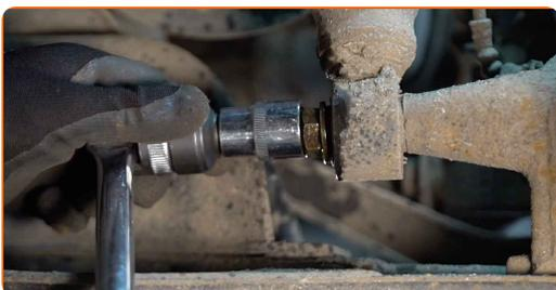
15 Desaperte a fixação superior do amortecedor. Use uma chave soquete nº 10. Use uma chave de catraca.
