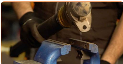
27 Coloque o amortecedor no arco da roda e fixe-o.
