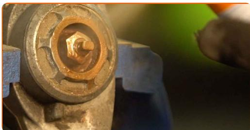
25 Instale a tampa protetora do suporte do amortecedor.
