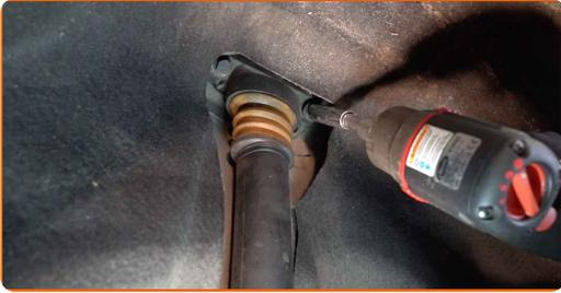
**29** Aperte a fixação inferior do amortecedor. Use uma chave combinada nº 21. Use uma chave soquete nº 21. Use uma chave de torque. Aperte-o para o torque de 130 Nm.
