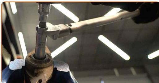
24 Trate do elemento fixador da haste do amortecedor. Use massa de cobre.
