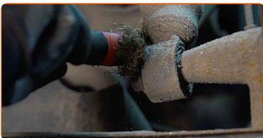
14 Desaperte a fixação inferior do amortecedor. Use uma chave soquete nº 21. Use uma chave de tarraxa.
