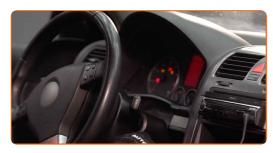
Desligue a ignição. No modo de serviço, os limpa para-brisas estarão na posição superior.
