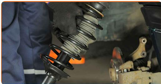
**34** Aparafuse a fixação superior de montagem do suporte do amortecedor.
