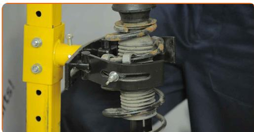
**20** Desaparafuse o elemento fixador do cabeçote do dispositivo amortecedor.
