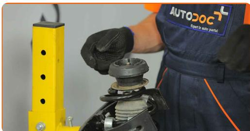
**30** Aperte a porca do suporte do amortecedor da haste do pistão. Use uma chave soquete nº 21. Use uma chave de torque. Aperte-o para o torque de 65 Nm.
