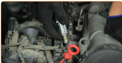
**11** Aparafuse as novas velas de ignição e aperte-as. Use o soquete da vela de ignição #21. Use uma chave de torque. Aperte-o para o torque de 25 Nm.
