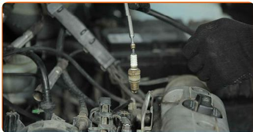
**9** Aplique uma camada fina de um lubrificante antigripante de alta temperatura específico às roscas das novas velas de ignição.
