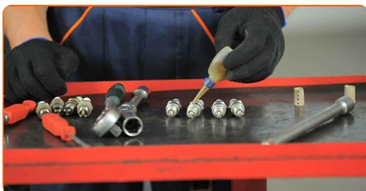
**10** Instale as velas de ignição novas nos seus locais de montagem. Use o soquete da vela de ignição #21.
