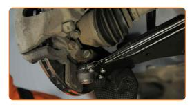
Aperte o fixador que liga a junta esférica à manga de eixo. Use uma chave combinada nº 18. Use uma chave soquete nº 18. Use uma chave de torque. Aperte-o para o torque de 50 Nm.
