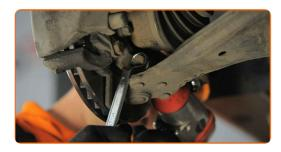
Remova o parafuso de fixação.
