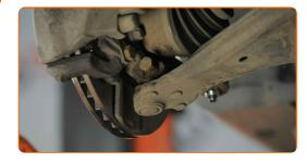
Limpe os elementos de fixação que conectam o braço de controlo à subestrutura. Use uma escova metálica. Use spray WD-40.
