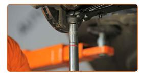
Aperte o fixador traseiro do braço da suspensão. Use uma chave combinada nº 18. Use uma chave soquete nº 18. Use uma chave de torque. Aperte-o para o torque de 90 Nm.+90°
