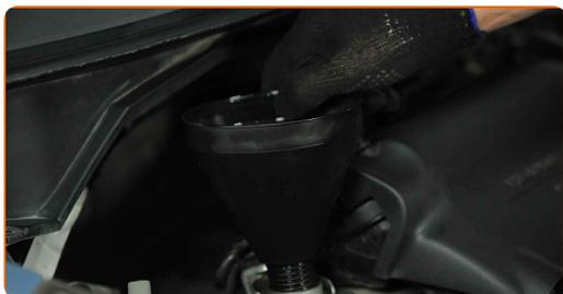
**18** Despeje o óleo no motor através do gargalo de enchimento de óleo. Quantidade necessária de óleo: 3,6 l.
