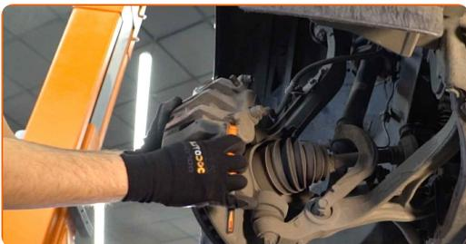
9 Desaparafuse a fixação de pinça de travão. Use uma chave soquete nº 13. Use uma chave de catraca.
