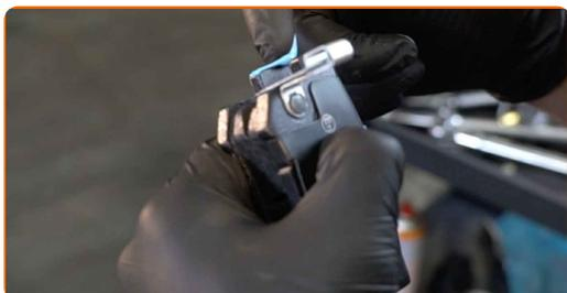
Substituição: pastilhas de travão – HONDA CIVIC VI Aerodeck (MB, MC).
