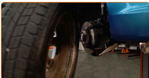
**7** Limpe os elementos de fixação da pinça de travão. Use uma escova metálica. Use spray WD-40.
