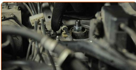
**22** Desapertar a fixação superior de montagem do suporte do amortecedor. Use uma chave soquete nº 14. Use uma chave de catraca.
