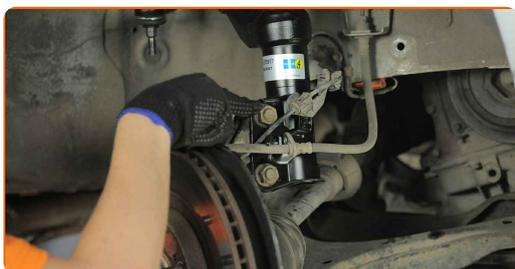
**15** Desparafuse o elemento de fixação inferior que liga a coluna de suspensão às mangas de eixo. Use uma chave combinada nº 19. Use uma chave soquete nº 22. Use uma chave de catraca.
