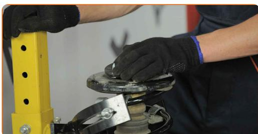
**34** Trate a haste da coluna do amortecedor. Use massa de cobre.
