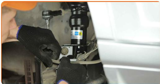
**14** Limpe os fixadores que conectam as colunas de suspensão às mangas de eixo. Use uma escova metálica. Use spray WD-40.
