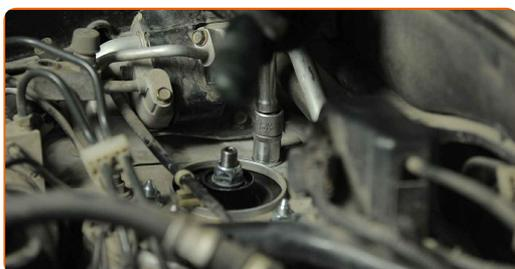
**39** Trate os fixadores do apoio da coluna de suspensão. Use massa de cobre.
