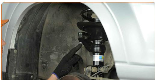
**8** Desenrosque a extremidade da porca de fixação da manga de eixo. Use uma chave combinada nº 17.
