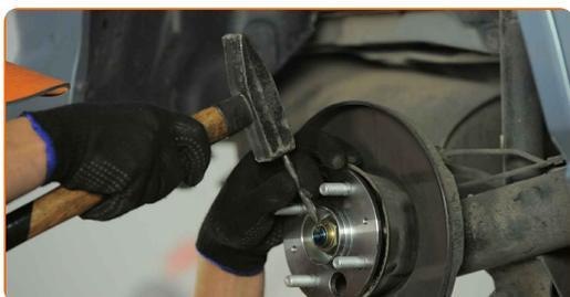
**26** Instale a tampa de proteção do rolamento do cubo. Use um martelo de borracha.
