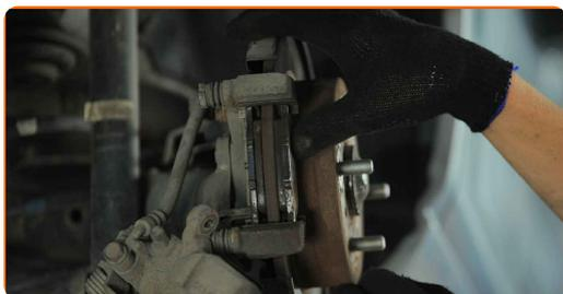
**35** Instale a pinça do travão e fixe-o. Use uma chave soquete nº 12. Use uma chave de torque. Aperte-o para o torque de 23 Nm.
