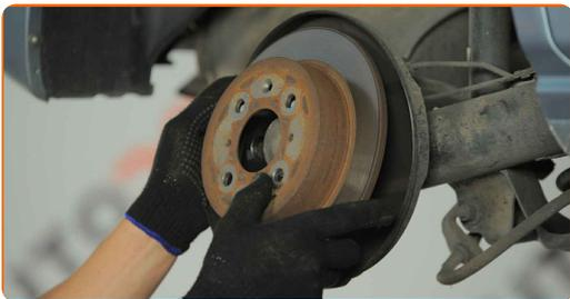
**29** Aperte a fixação do disco de travão. Use a chave Phillips. Use uma chave de torque. Aperte-o para o torque de 10 Nm.
