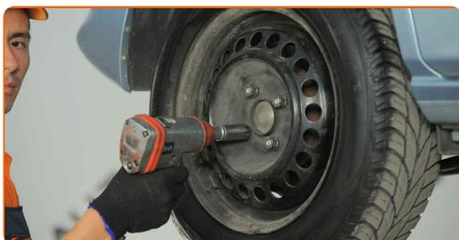
**40** Baixar o carro e trabalhar em ordem transversal, apertar os parafusos das rodas. Use o soquete de impacto para roda #19. Use uma chave de torque. Aperte-o para o torque de 108 Nm.
