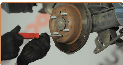
**30** Limpe a braçadeira da pinça de travão de sujidade e poeira. Use uma escova metálica. Utilize um produto de limpeza para travões.
