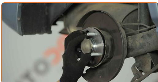
**27** Trate o cubo onde entra em contacto com o disco de travão. Use massa de cobre.
